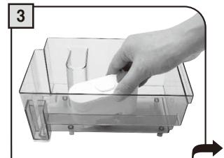
空のタンク内に挿入して、基準マークを溝にあわせてください。
