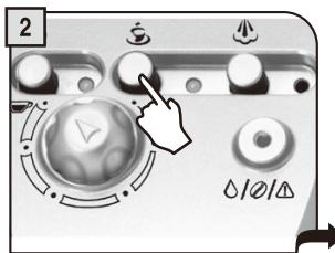
コーヒーボタンを2度続けて押してください。連続抽出されます。（抽出中はコーヒーランプが2度ずつ点滅します）
