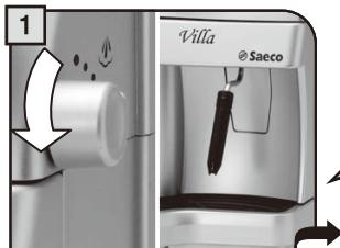
ミルクの泡立てを行った時は、必ず左記の作業を3回繰り返してください。ミルクの成分が内部で固まりノズルが詰まります。
